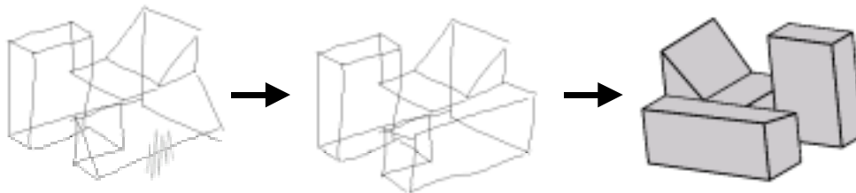
Figura 5. Modificación interactiva del boceto, y actualización automática del modelo
